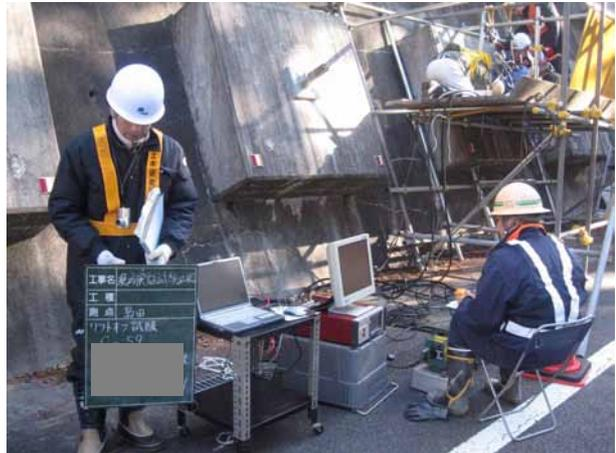
写真 5.13 リフトオフ試験状況（例）
