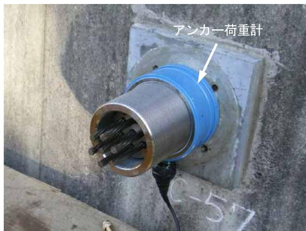
写真 5.6 アンカー荷重計の取付け（例）
