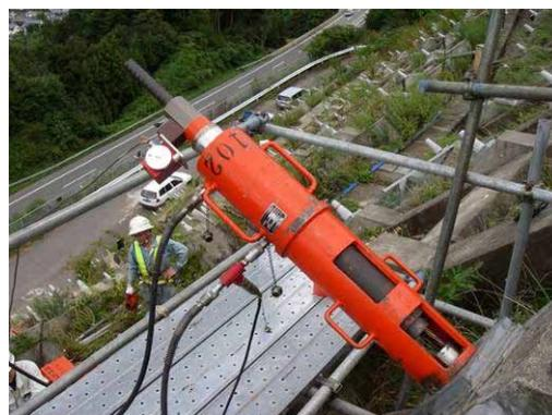
写真 1.1 リフトオフ試験による計測
