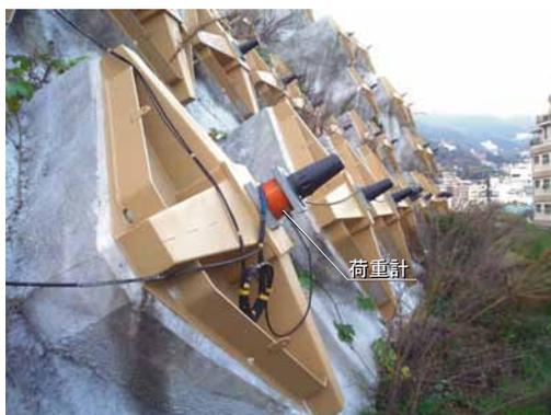
写真 1.2 荷重計による計測
