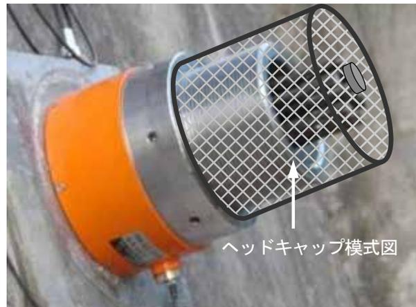
写真 5.15 ヘッドキャップ取付け（例）
