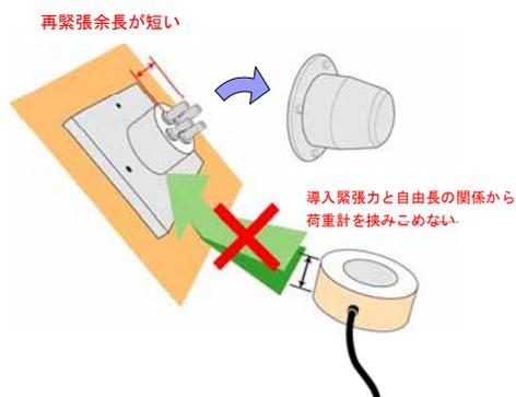
図 1.3 荷重計交換・新規設置時の問題点
